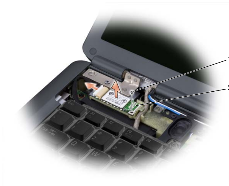
1 крепежный винт 2 плата
